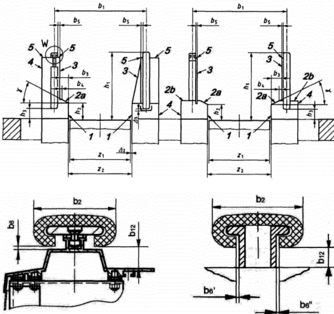
Рисунок 2 - Эскалатор (вид в разрезе), основные размеры
