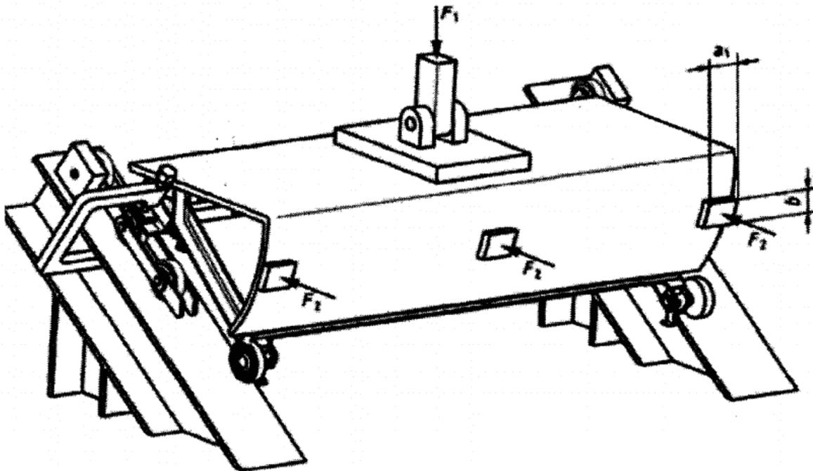
Пояснения:  $F_1 = 3000 \text{ Н}$ ;  $F_2 = 1500 \text{ Н}$ ;  $a_1 = 50 \text{ мм}$ ;  $b = 50 \text{ мм}$
